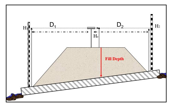
Pipe Slope= $(H_2-H_1)/(D_1+D_2)$ Fill Depth= $((H_1+H_2)/2)-H_e+(P_{dia}/12)$
