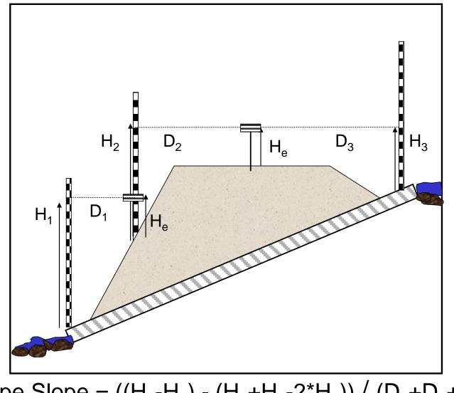
Pipe Slope =  $((H_3-H_e) - (H_2+H_1-2^*H_e)) / (D_1+D_2+D_3)$ Fill Depth= $((H_3-H_e) + (H_2+H_1-2^*H_e))/2 + (P_{dia}/12)$
